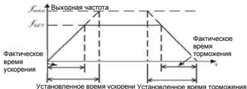
Рис. 6-1. Время ускорения и время торможения
