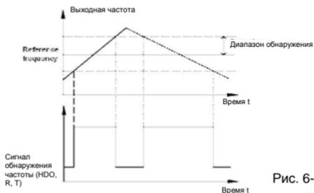
Рис. 6-20 Определение выходной частоты
