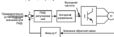
Рис. 6-22 ПИД-регулирование
