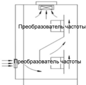
Рис. 3-2. Установка двух и более преобразователей частоты
