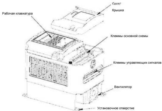
Рис. 2-1. Наименование компонентов преобразователей частоты мощностью 0,75 кВт – 18,5 кВт
